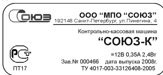
Рисунок 1 Внешний вид шильдика с маркировкой ККМ (Зав. № ККМ на рисунке условный)
